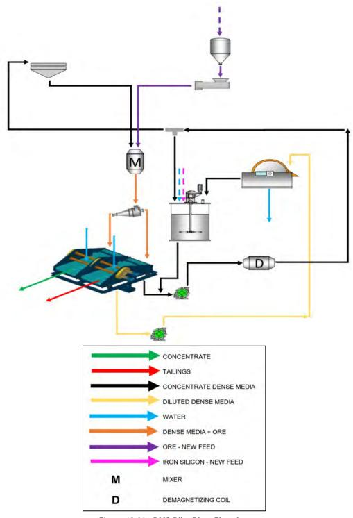
Figure 13-26: DMS Pilot Plant Flowchart
