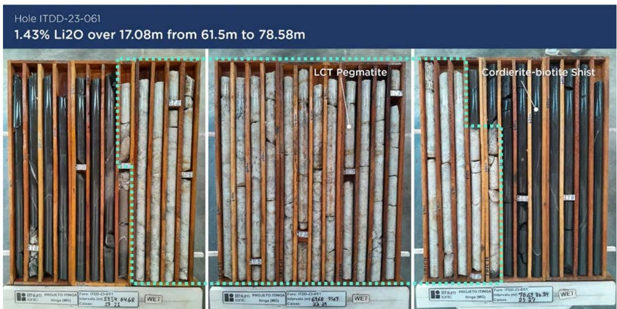
Abbildung 3: Foto des Kerns aus Bohrloch ITDD-23-061 von Abschnitt LT 300
